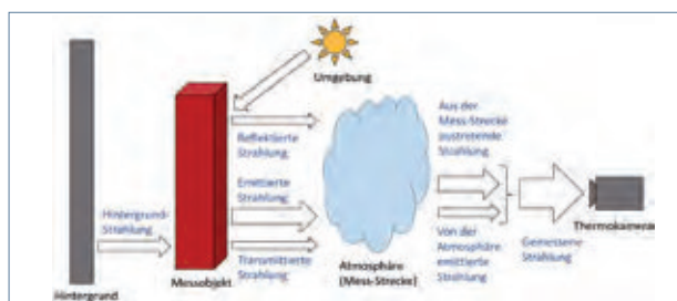
Abbildung 1: Thermografische Szene mit Strahlungsanteilen, deren Summe die gemessene Strahlung ergibt. Aus dieser wird die Temperatur des Messobjekts berechnet
